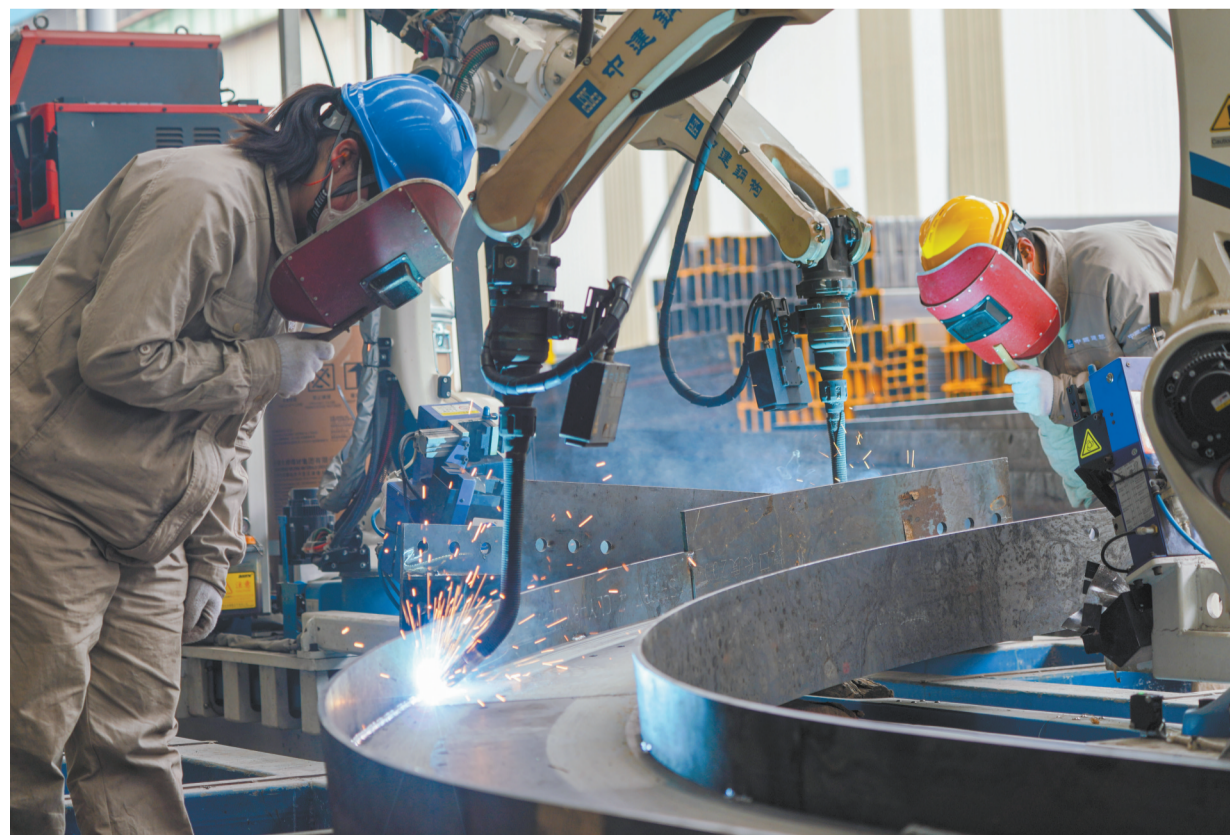
在四川眉山天府新区中建钢构四川有限公司加工车间里,机器人操作员在观察机器人焊接钢构产品的焊接点(2026年3月23日摄)。(新华社发)
